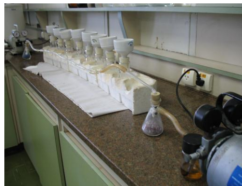
FIGURA 10. Filtragem do clínquer moído e passante titulado com ácido clorídrico.
